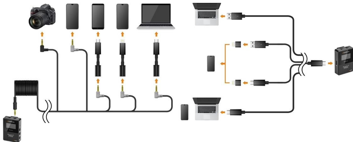
BoomX-D PRO D2 本体に USB Type-C や 3.5mm イヤホンジャックが搭載されており、両方も音声出力が可能のため、カメラ・スマートフォン・パソコンなどの主要機器にすべて対応できます。
