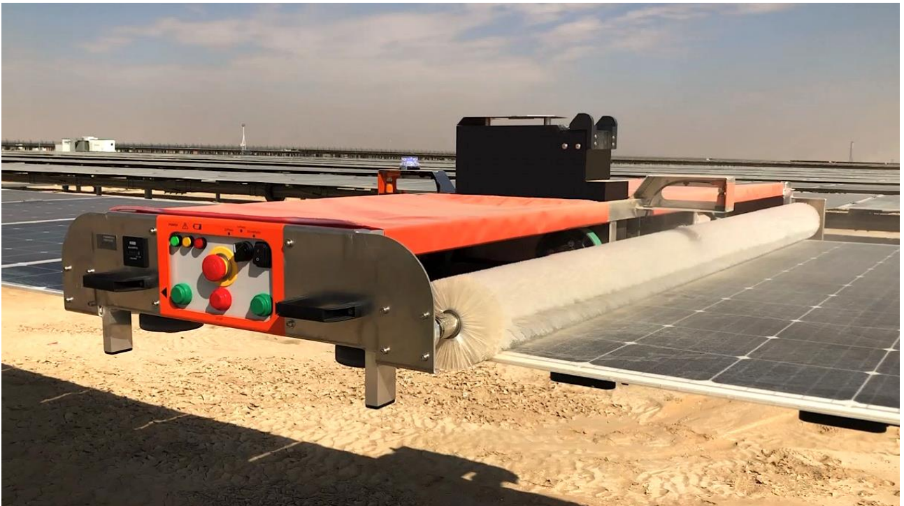
稼働中のソーラーパネル清掃ロボット Type4
