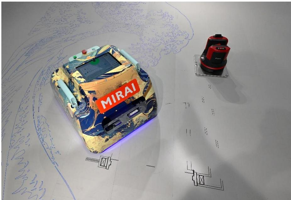
建設現場における「墨出し」は設計図面に基づいて建物の基準となる線や点を現場に直接マーキングする作業です。これにより建物の位置、寸法、水平・垂直の基準が明確になり、工事が正確に行われることが保証されます。当社墨出しロボットは設計データをもとに測距器（ライカジオシステムズ社製）で正確な現場位置を確かめながら 1mm～3mm（ロボットと測距器の距離による）という精度の高い墨出しを自動で行うことができます。
