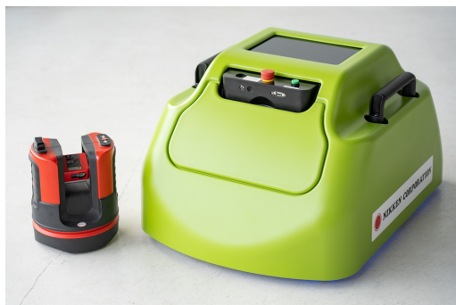
測量機(左)と墨出しロボット(右)
