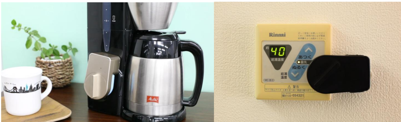
「SESAME mini」に拡張ホルダーを取り付け、コーヒーやお風呂のオン・オフに使用している様子
