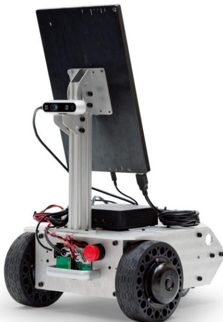
台車ロボット用 デプスカメラオプション 開発例 (メガローバーVer.3.0に、デプスカメラオプション、拡張機器用電源基板 VS-WRC054、 ROS PC(NUC14)オプションおよび小型ディスプレイを搭載した例)
