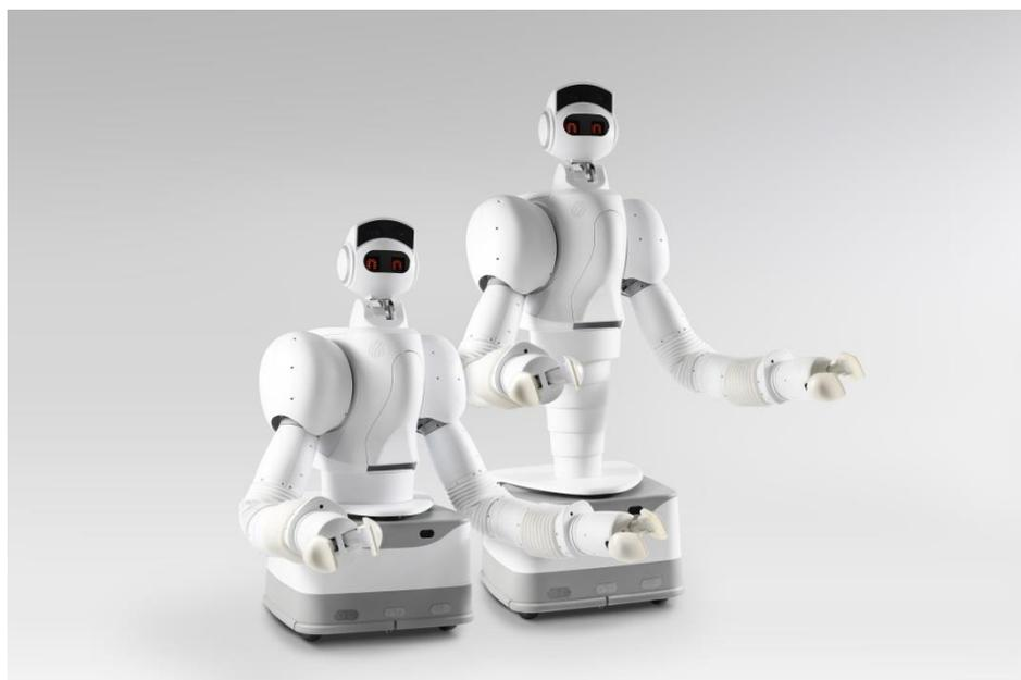
AI・機械学習機能搭載型ヒューマン支援ロボット『アイオロス・ロボット』は、人、顔、モノ、テキストなど、周囲の環境・情報を学習・認識できる非常に優れた「AIビジョンセンサ」を搭載し、人が後ろ向きや横たわった状態でも同一人物であることを認識できる「高度な物体検知能力」とともに、「空間認識機能」、「生体信号検知機能」を有しております。また、「音声認識機能」を備えているため、音声で指示を送ることも可能です。
