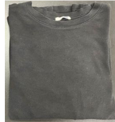
250回洗濯乾燥後(縦型洗濯機、標準コース、当社従来洗剤使用)
