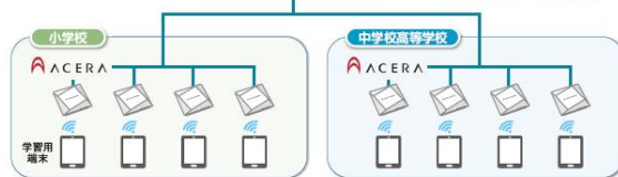
小学校の校舎と中学校高等学校の校舎に設置した約120台のアクセスポイントをUNIFASで集中管理
