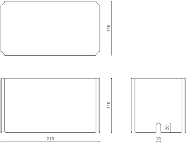
鉄板を折り曲げてできたケーブルボックスです。側面の切り欠きと四隅のスリットからケーブルを通すことができ、四隅のスリットがあることで内部に熱がこもりにくくなっています。乱雑になりがちな配線をすっきりとまとめ、埃を防ぎます。
