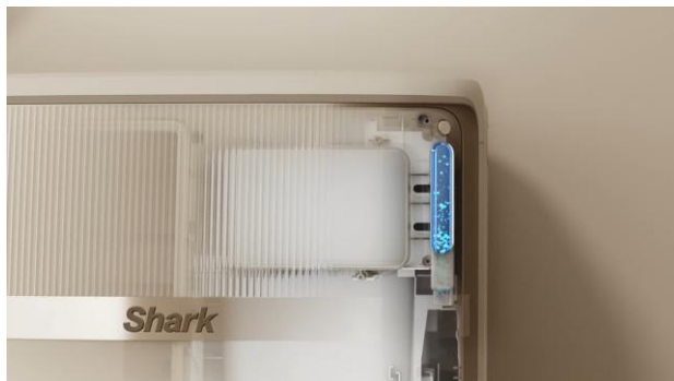
水道水から電解水を自動お手入れドック内部で自動生成
