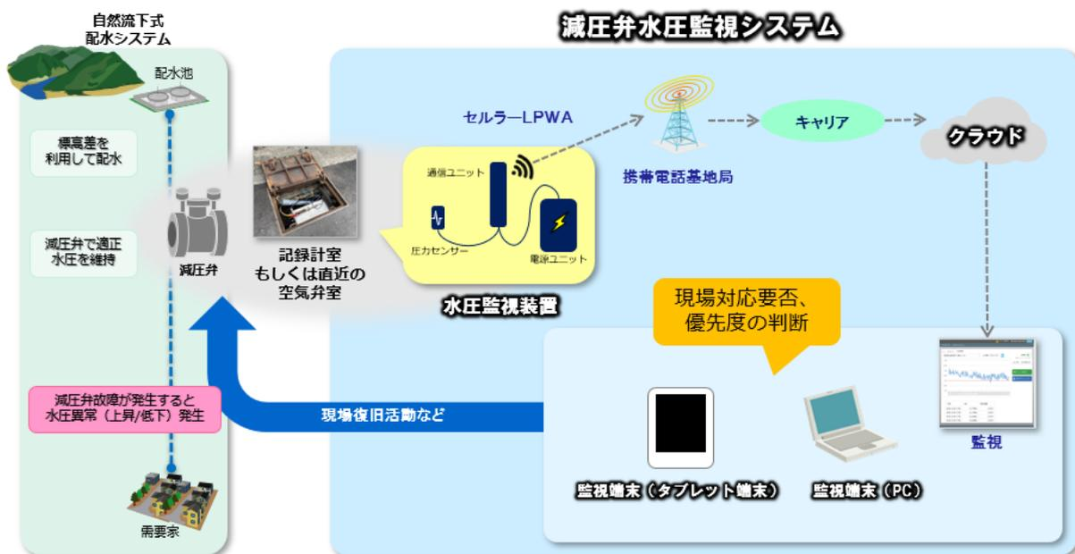
減圧弁水圧監視システムの概要
