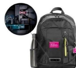
このバックパックは、ダイソンの空気清浄機に使用されているセンサー技術を活用し、移動中に空気質のデータを収集することができるポータブルの空気質測定装置です。微粒子センサー、ガスセンサー、バッテリーパック、GPSを内蔵し、バックパック周辺の空気の状態を確認することができます。
