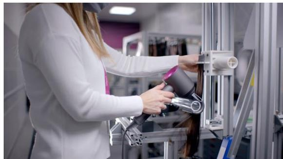
「従来の常識を覆すことに情熱を燃やす当社のエンジニアは、气流へのこだわりから、ヘアスタイリストがブラシとドライヤーを使って浮き毛を抑えるテクニックを観察し、コアンダの可能性を追求しました。従来、このテクニックは、スタイリストがロールブラシを使って髪を束ね、ドライヤーの風を当てて浮き毛を毛束に押し込んで目立たなくするものでした。私たちは、この方法を機械化して、毎日のスタイリングに提供できるような革新的な方法を模索しました。新たに開発した『浮き毛抑制ツール』はコアンダ効果を利用して、髪に過度な熱ダメージを与えることなく、浮き毛を目立たないようにします。」
