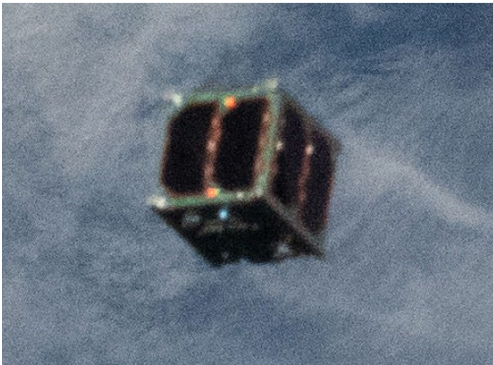
ISS から放出後、LED の点灯により起動を確認(画像提供:JAXA/NASA)
