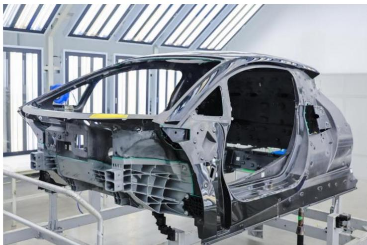
「YANGWANG U9」の超高性能と高い品質基準を満たすため、中国深汕に専用工場を設立しました。この工場は、中国国内初の新エネルギースーパーカー専用工場です。「YANGWANG U9」は、国内初の量産モデルとしてカーボンファイバー製の車体構造部品を採用し、世界最大の単体カーボンキャビンを使用しています。このカーボンファイバーは、強度が鋼の5倍～6倍に達します。
