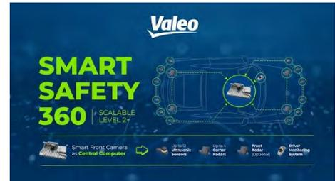
ヴァレオ・スマート・セーフティ 360 システムでは、スマート・フロントカメラがアーキテクチャの中心になります。ヴァレオ・スマート・セーフティ 360 は、統合されたアフォーダブルでスケーラブルなシステム・アプローチにより、最新のEU一般安全規則 (GSR) と新車アセスメントプログラム (NCAP) の要件などの安全基準を満たす L2/L2+ ADAS 機能を統合します。OEMの仕様に応じて、フロントカメラを超音波センサーやレーダーに接続し、中央コンピューターとして使用できます。このスケーラブルなアプローチにより、OEMは、さまざまなタイプの安全センサーとADASセンサーがフロントカメラベースのアーキテクチャに統合できるため、個々のECUを削除してコストと効率を最適化できます。
