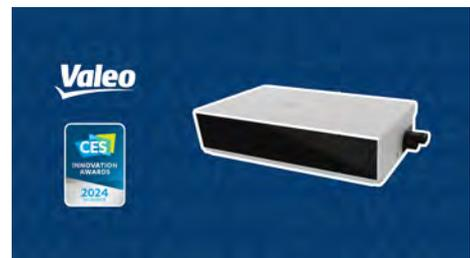
ヴァレオ SCALA™ 3 はエネルギー効率が非常に高く、消費電力は15ワット未満です。コンパクトな形状で車両のバンパーとルーフに搭載できるモデルを設計されています。SCALA™ 3 には、ハードウェア機能に加え、高度なLiDAR認識と、物体、車線、ランドマーク、障害物、雨や水しぶきの検出、オンライン校正、位置ずれ検出、サービス校正などの機能を可能にする一連のソフトウェアも装備されています。これらのソフトウェア・モジュールは、Qualcommなどの主要な SoC (システムオンチップ) プラットフォームに簡単に統合でき、ドメイン・コントローラーまたは専用ECU上で実行できます。
