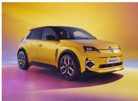
フロントのヘッドランプには、電子部品を一体化したリフレクターモジュールであるヴァレオ「Monolag」が組み込まれており、究極の軽量化と低消費電力を実現しています。信号灯は、リフレクターモジュールの光線の前面にある透明なマイクロ・オプティクスによって制御され、ヘッドランプの光線を妨げることなく、ユニークな3D効果のシグネチャーを実現しています。
