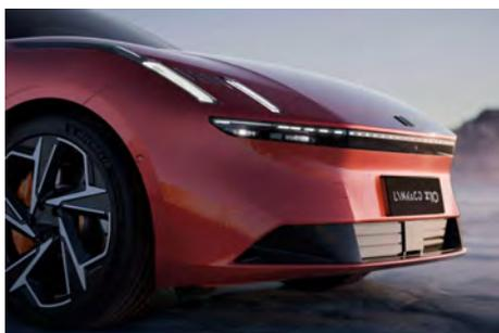
Lynk & Co Z10の空力デザインは、レンズ高さわずか15mmのThinBiliteモジュールを搭載した薄型のヘッドランプと初のRGBアプリケーションによって強調されています。このRGBアプリケーションは224個のLEDを制御し、256色を表示できます。これは、ヴァレオが開発した外装照明用のRGB LEDの最初の適用例であり、カラフルなアニメーションをもたらします。
