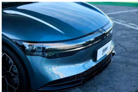
ヴァレオブースにフロントフェイスが展示されるZeekrの最新モデルは、ADASセンサーをシームレスに内蔵したイルミネーションロゴによってブランドアイデンティティを高めています。ヴァレオのレンズ高さ15mmのバイファンクションヘッドランプThinbilite15と1,700個以上のLEDで構成される2台のデジタルパネルを備えた革新的なフロントフェイスのおかげで、従来の自動車のセグメント化されたデザインから脱却し、最新の技術要素をシームレスに統合しており、ユーザーはパーソナライズされたインタラクティブなライティングを体験できます。ヴァレオは、エキサイティングな車室空間を演出するインテリアライティングも提供しています。
