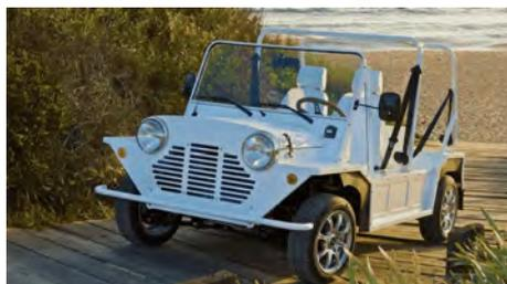
ヴァレオは、48V ソリューションによって、軽量の e-4 輪車セグメント向けのアフォーダブルで軽量のEVも提案しています。60年代にインスピレーションを得た超軽量車両であるKate Originalは、ヴァレオeAccess パワートレインを搭載し、重量はわずか 450 kgながら、130 kmの距離を走行できます。この経済的で楽しい車はフランスで製造されています。
