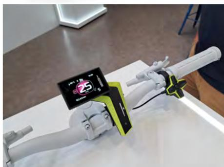
ヴァレオCyclee™ は、スマートドック、2 インチ タッチディスプレイ、回転式スロットル付きリモコンで構成されたスタイリッシュなHMI (ヒューマン・マシン・インターフェイス)を提供します。このHMIは、複数の組み立て位置と取り外し可能なディスプレイにより、市街地から山岳地帯までシームレスに移行します。ヴァレオ・スマートドックの Phone-as-a-Key システムは、ライダーが3メートル離れると eBike を自動的に
