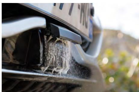
自動運転L2+からL4までのアプリケーションの開発をサポートするために、ヴァレオはLiDARやカメラなどの光学センサーを洗浄するさまざまなシステムを開発しました。ヴァレオのソリューションは、欧州とアジアのOEMのL2+/L3車両向けにすでに量産が始まっています。
