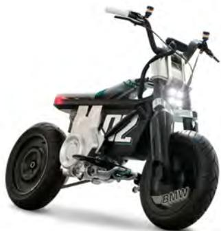
新型BMW CE-02バイクにも 48V 電動モーターが搭載されています。このバイクには、最大9kWの連続出力と14kWのピーク出力を発生できるコンパクトな空冷式 48V 電動モーターが組み込まれています。BMWはこのeMotorBikeを4kWと11kW の2種の出カバージョンで提供しています。走行距離100kmで毎日の使用や週単位の使用にも最適なソリューションです。
