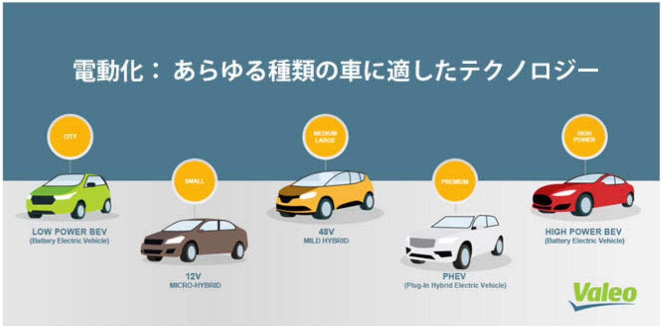
ヴァレオは、現在では世界中で多くの車に搭載されるようになったストップ・スタートシステムを最初に考案し、12V システムを年間約 2,500 万台生産しています。ストップ・スタートと同じように、これらのシステムも制動時の回生エネルギーを回収することで内燃式エンジンの効率向上に貢献しています。
