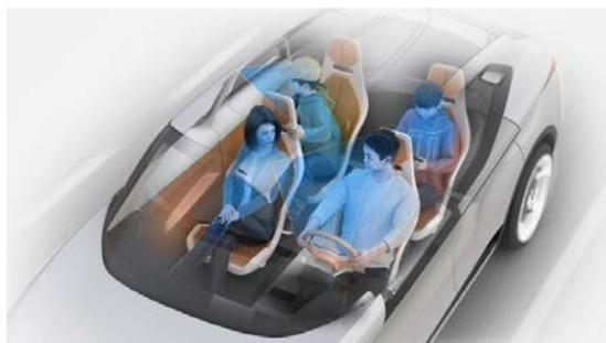
CES 2018 でヴァレオは、エンジン停止状態での車室内の乗員の有無を検知するソリューションを出展します。車室内に設置した複数のセンサーが乗員の人数、位置、形態を識別します。このヴァレオのテクノロジーを搭載した車は、サウンドとライトによるアラーム、およびユーザーのスマートフォンにメッセージを送り、停めた車への乗員の置き去りを防止します。
