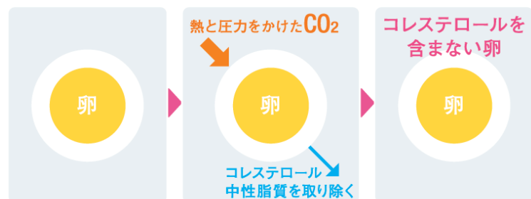
熱と圧力をかけた二酸化炭素には、コレステロール・中性脂質がよく溶ける性質があります。
