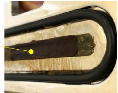
図4 平板電極への卵成分の焦付き
