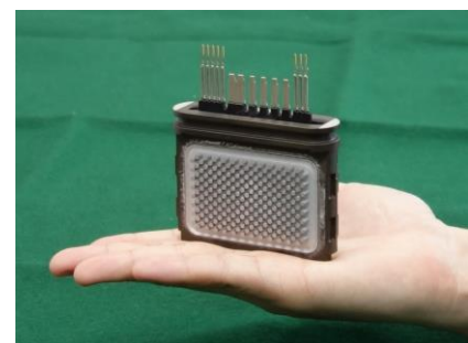
インバーターに内蔵されている小型高効率 両面冷却パワーモジュール
