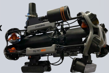
■CHASING M2 PRO MAX + マルチビームソナー OmniscanF450 など
