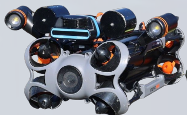
■CHASING M2 PRO MAX + マルチビームソナー OmniscanF450 など
