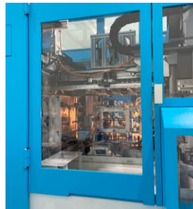
ペレットからプリフォーム、PETボトルを成型
