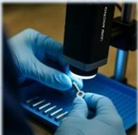
従来、拡大鏡による外観検査は自動化が難しく、検査履歴の確保や基準の統一に課題がありました。POKAMIRUを後段に組み合わせることで、検査基準を標準化するとともに、全ての検査画像を保存し、管理者が履歴を確認できる仕組みを実現しました。
