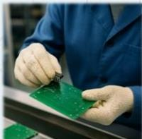
基板実装におけるDIP部品の手作業では、平均で数%のミスが避けられませんでした。さらに、短納期の仕事はプレッシャーが重なりミスが連発してロットアウトに至ることもありました。しかしPOKAMIRUを導入したことでのんびり工程に入る前に不具合を検知できるようになり、実装ミスを大幅に抑制することができました。
