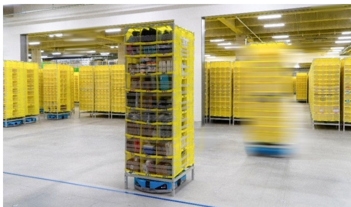
商品棚を持ち上げて働く方々のもとに移動する「Amazon Robotics」。在庫商品を保管し、お客様の注文に応じて商品をピッキングする時間を削減することができます。
