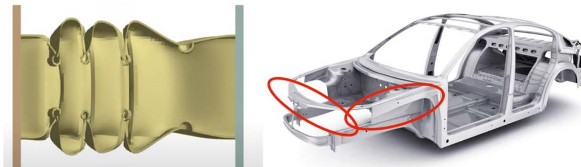
座屈の進展パターン、すなわち衝突時に部材がどのように折りたたまれて壊れるのかを制御することで衝撃吸収性を大幅に向上させると同時に、軽量化を達成します。
