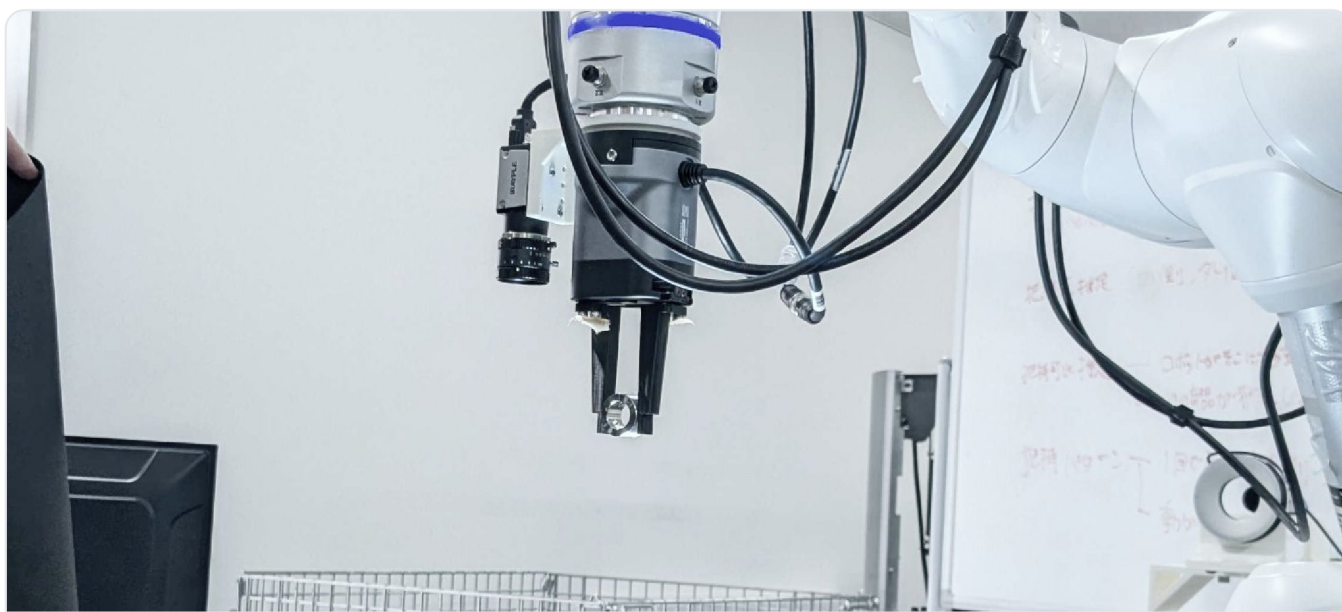
TPIM01 バラ積み状態の旋削品をAIロボットが自律的にピッキングし、外観検査から仕分けまでを実行
