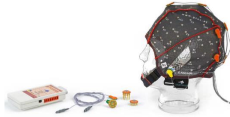
図 解析に用いた脳波測定機器 (g.SAHARA dry active electrode system, g.tec 社製)
