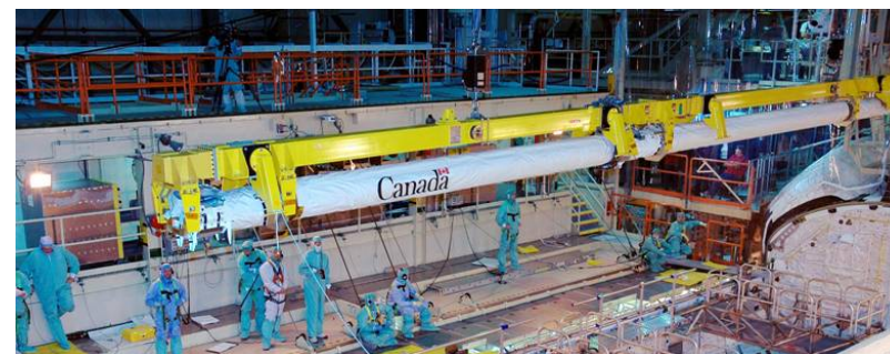
スペースシャトルに搭載作業中のOBSS
