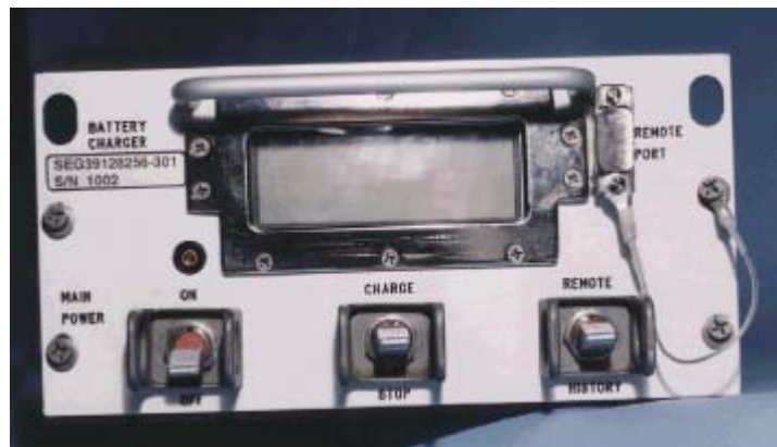
バッテリー充電装置
