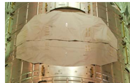
船内実験室上部CBMの断熱カバー
