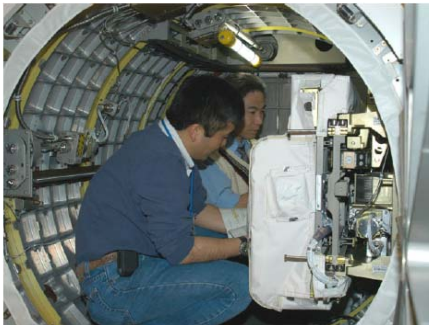
「きぼう」のエアロック内部の状況 (打上げ時の固定器具の取り外し作業訓練)
