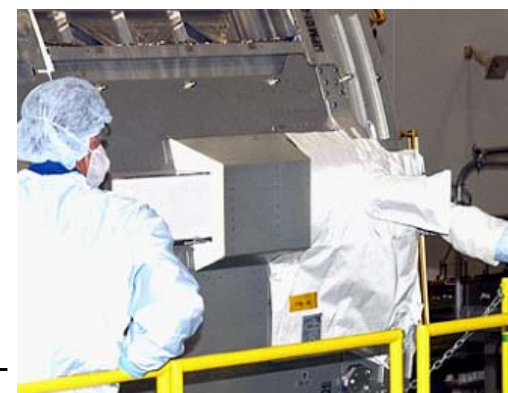
トランニオンピン用の断熱カバー
