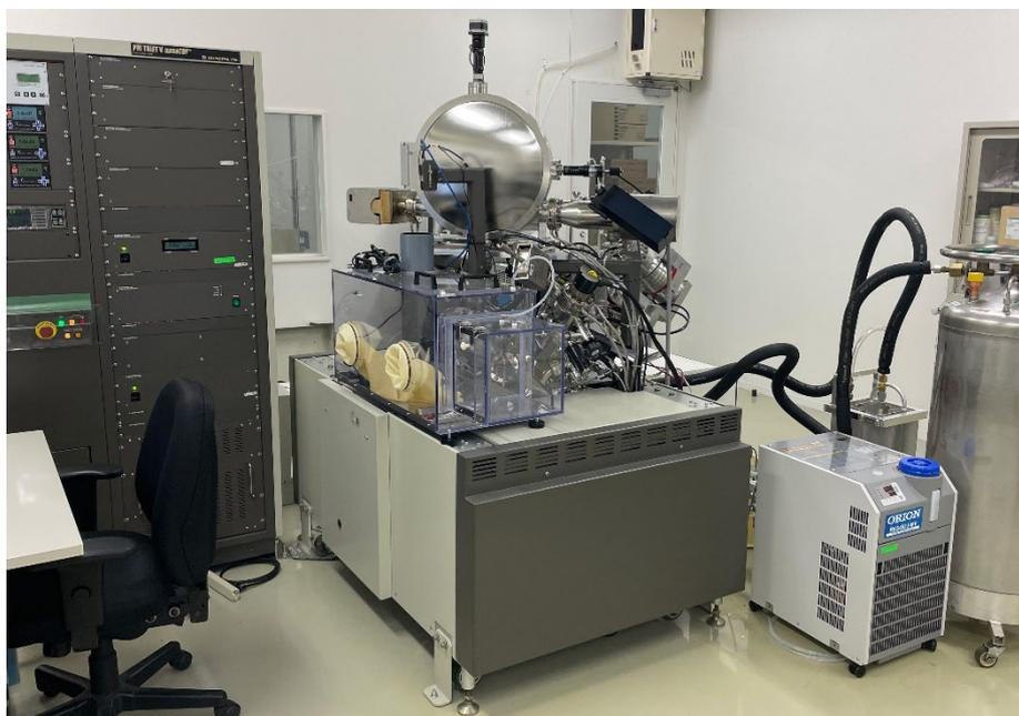
図3 3次元凍結質量イメージングの解析装置
