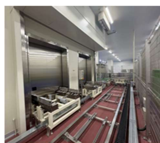
塩せき肉の搬送や塩せき時間の管理を自動化する自動ラック倉庫
