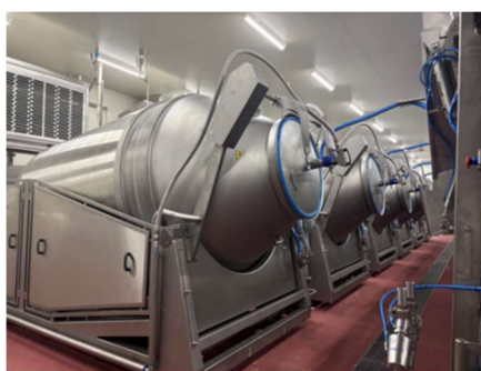
原料の解凍工程における水使用量の削減に貢献する解凍タンブラー
