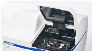
手順1： APX100にサンプルをセットし、蓋を閉じる。
