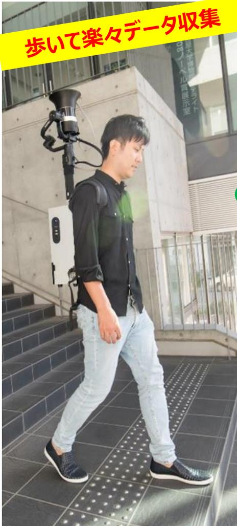
SEAMS (シームス) は、バックパック型の本体に、3DLiDARやカメラ、各種センサーを搭載し、歩きながら周囲環境（全周360度）の3次元点群データを取得するシステムです。
