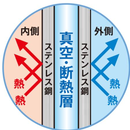
ステンレスボディの間に真空状態を生み出しました。これにより冷たい飲み物には外気の熱が伝わりにくく、温かい飲み物は熱が逃げづらい仕組みになっています。
