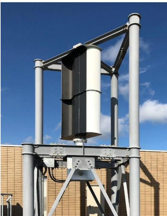
写真1 垂直軸型サボニウス式風車
