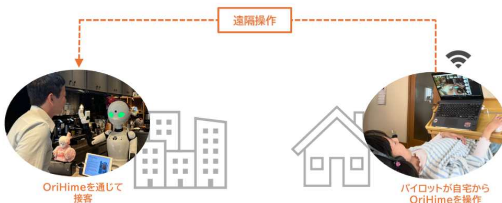
分身ロボット「OriHime」の仕組み
