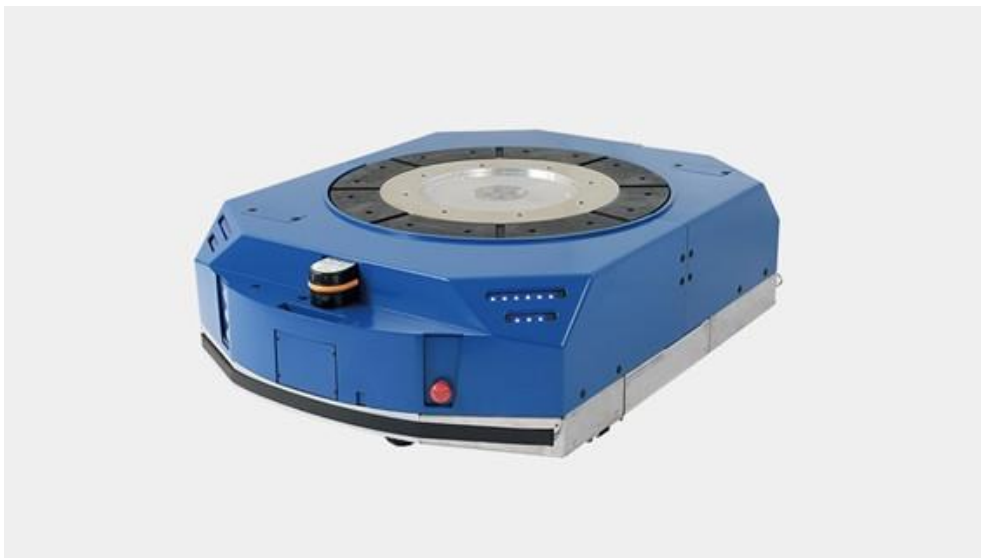
500kgまで対応可能な棚搬送ロボット『TA-G 500』
