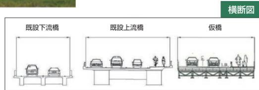
橋梁本体工事に先立ち、平成27年度に人や車の通行を確保するための仮橋工事に着手し、平成30年度に仮橋に交通を切り回しました。その後、下流橋の撤去工事を進めながら、新しい橋脚等を施工していきました。
