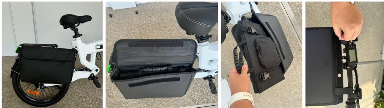
後部キャリアに装着した専用バッグに常時搭載可能。取り出して展開。盗難ロックをして、ハンドルバーと固定。
