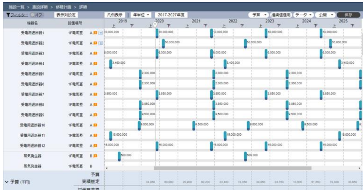
図1 複数の設備の修繕計画をガントチャートで可視化した画面
