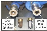
純正の金属メッシュフィルターに対し、樹脂製薄膜フィルターの採用により、従来では取りきれなかった微細な異物も、もれなくキャッチします。
