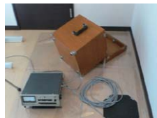
壁空間音圧 測定用スピーカー
