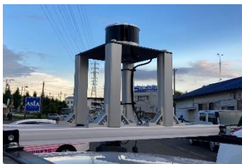
車両上部に装備したセンサーで周囲の状況を認識、車内カメラにて運転者の目・鼻・耳の動きを認識し、確認行動の有無を確認しています。
