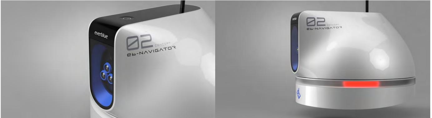
2mクラスの無人操船トリマランヨット（帆船型ドローン）「Type-A プロトタイプ」で実証実験を重ねたノウハウを集約し、遠隔から自動操船するコントローラーと通信部分をユニット化いたしました。
