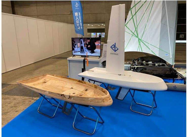
Type-M1 は全長 1m クラスのモノハル・ウイングセールボートで、小型魚探が搭載可能です。小型モーターボートからローンチし、周囲の魚群探知や、デプスマッピング（海底地図作成）として誰でも手軽に利用できることを想定したコンセプトモデルです。
