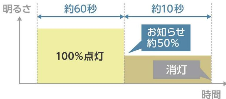
自動消灯の約 10 秒前に約 50%の明るさに減光してお知らせします。この 10 秒の間にセンサーが反応した場合は、すぐに 100%点灯へ戻ります。
