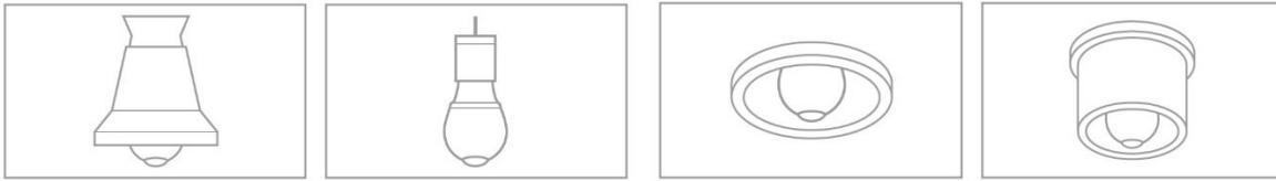
センサーを覆うと検知しないため、下向きの開放型器具専用となります。
