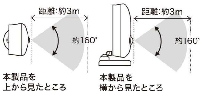
明暗センサーで周囲が暗く(約 20lux)なったことを検知し、人感センサーで上図の範囲内での人や動物の動き(熱)を検知して約 30 秒間、自動で点灯します。
