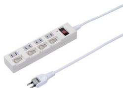
●ブレーカー機能を兼ね備えた電源を一括でON/OFFできる、節電に便利なブレーカー内蔵集中スイッチ。1500Wを超えた状態で使用すると、ブレーカーが自動で作動し、電源をOFFにします。
