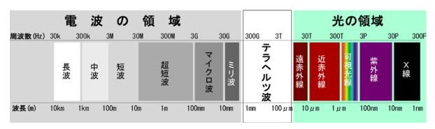
光と電波の両方の特性を兼ね備えているテラヘルツ波は、布、紙、木、プラスチック、陶磁器を透過し、金属や水は透過しない特性を持つため、物体内部の透過像の取得や分子相互作用の検出が可能です。セキュリティ分野や分光分析分野(物質に入射した光が、物質に含まれる原子や分子の種類に特徴的な変化を示すことを利用した分析)などへの応用に大きな期待が寄せられています。
